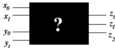
Abbildung 2: Blackbox für einen Zwei-Bit-Addierer
