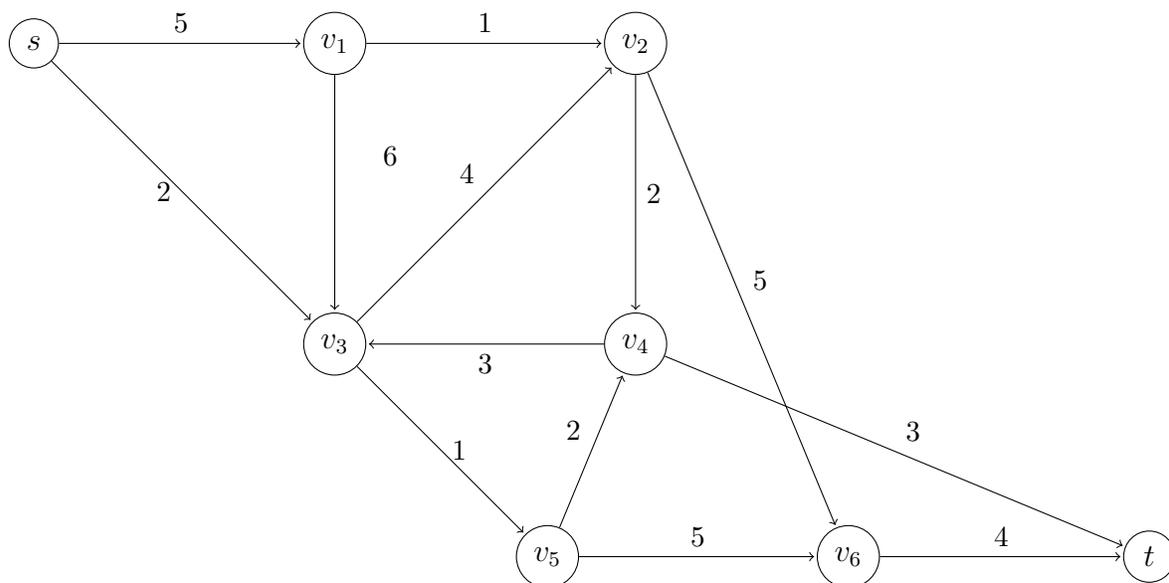
Bestimme mit Hilfe des Algorithmus von Ford und Fulkerson einen maximalen  $s$ - $t$ -Fluss im Netzwerk  $(G, u, s, t)$ . Gib jeweils den Residualgraphen an.
