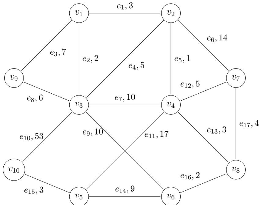
Bestimme mit Hilfe des Algorithmus von Dijkstra einen kürzesten Weg von  $v_1$  nach  $v_{10}$ .
