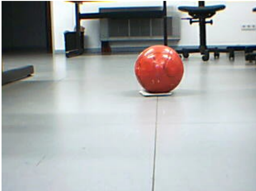
Abbildung 4: Der Ball wird aus einer 1.8 m Entfernung nicht erkannt
